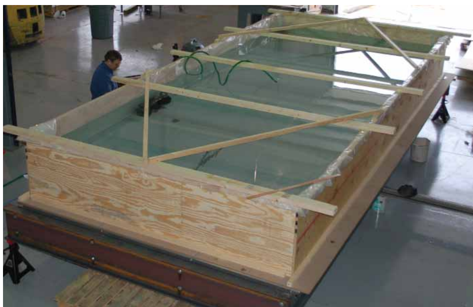
Cornerstone Specialty Wood Products recria uma condição de uma carga uniformemente distribuída em uma grande plataforma de teste.
