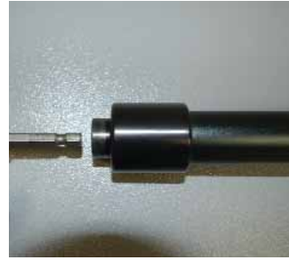
Introduzca la broca en el extremo del poste de extensión.
