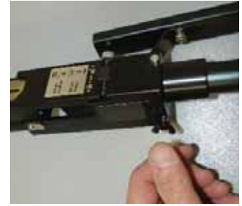
Instale el accesorio del tornillo asegurando que está sentado. Apriete la tuerca de mariposa hasta ajustada.
