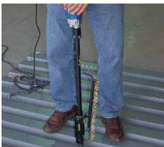
Opere el interruptor para encender el motor y presione el cabezal con fuerza constante contra la superficie de trabajo. No quite la herramienta del trabajo hasta que el embrague se desconecte y la broca se detenga, lo que significa un tornillo completamente instalado. El próximo tornillo quedará en posición cuando retire la herramienta de la superficie de trabajo. Este instrumento tiene un embrague que detecta profundidad y automáticamente se desconectará, emitiendo un clic de trinquete, lo que significa un tornillo sujetado.
