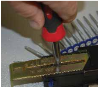
Quite el tornillo con un destornillador Phillips. Alinee las marcas del cabezal con el seguro maestro para elegir el largo adecuado del tornillo. Para apretar el tornillo, baje el cabezal usando presión ligera. Apriete el tornillo para asegurar que esté ajustado con la placa deslizante.
