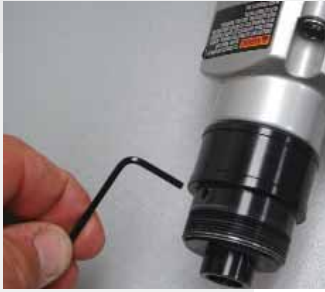
Apriete el tornillo de presión del adaptador.
