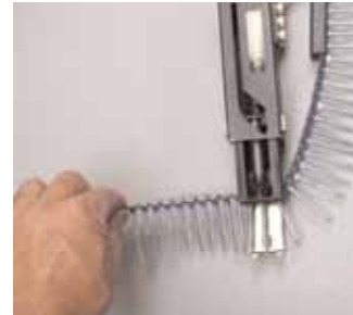
Para retirar la tira, jale de ella a través del cabezal.
